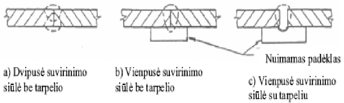
1 pav. Išilginių sudurtinių suvirinimo siūlių pavyzdžiai
