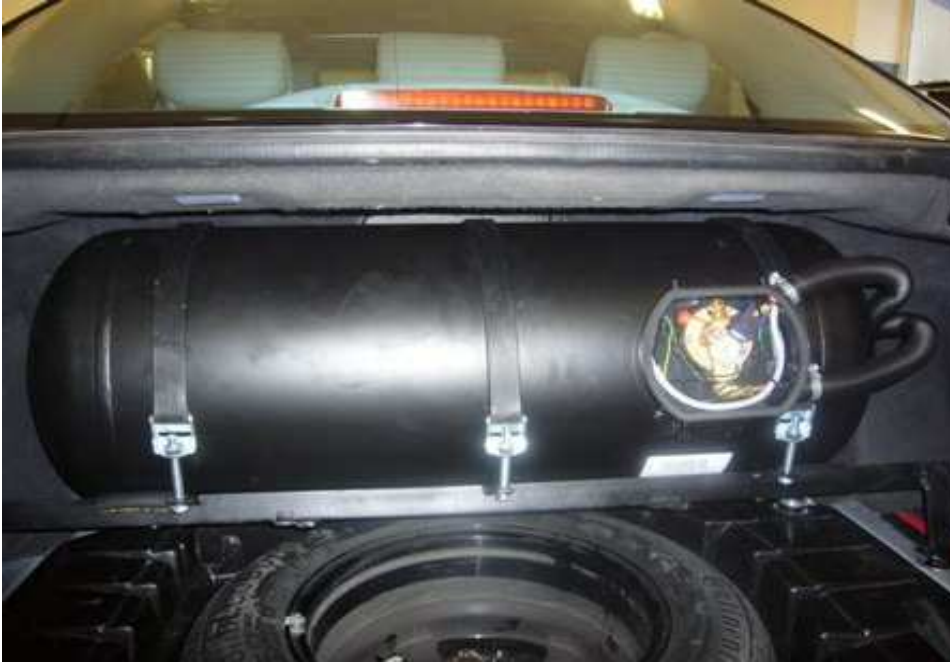
3 fotografija. Cilindrinio baliono virš 85 l talpos tvirtinimas automobilio bagažinėje.
