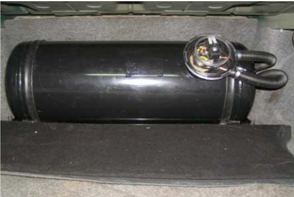
2 fotografija. Cilindrinio SND baliono iki 85 l talpos tvirtinimas automobilio bagažinėje.
