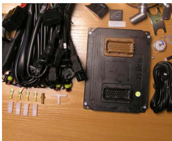
13 fotografija. Elektroninis valdymo blokas OSCAR- N su priedais (gam. tipas ECU 6C; ECU 8C).
