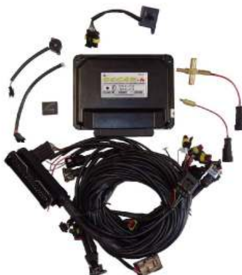
12 fotografija. Elektroninis valdymo blokas OSCAR- N su priedais (gam. tipas ECU 4C).
